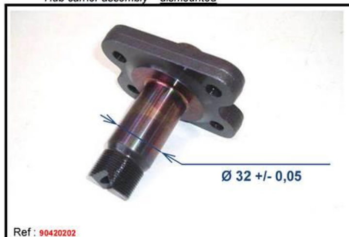
H3-1) Porte moyeu assemblé – déposé Hub carrier assembly – dismounted
